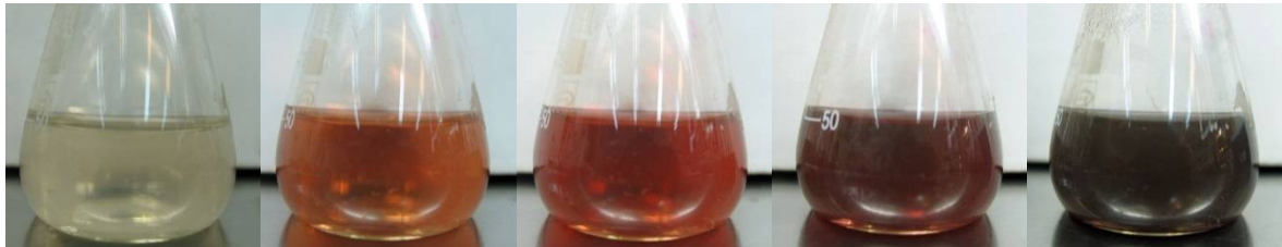
شکل 1 از چپ به راست مراحل مختلف تغییر رنگ واکنش و تولید نانوذرات نقره با استفاده از عصاره متانولی میخک
